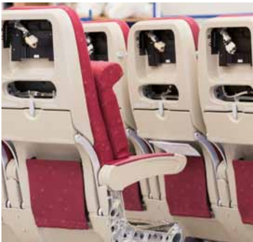
Durch das neue Rückenlehnenkonzept kann enger bestuhlt werden, ohne den Sitzkomfort einzuschränken.
